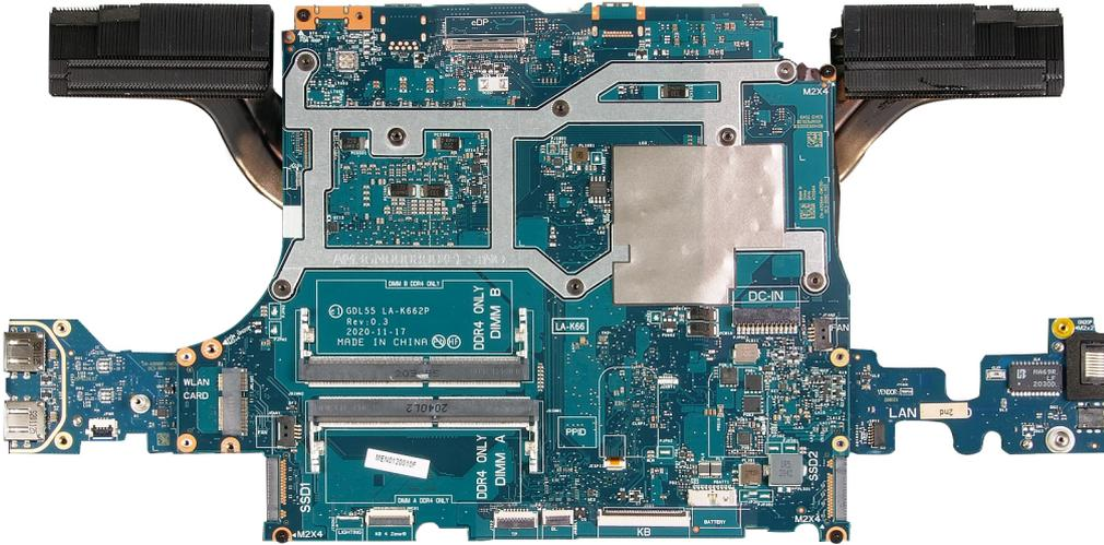
11. Gire la tarjeta madre y extraiga la tarjeta de I/O, la placa USB y el disipador de calor.
